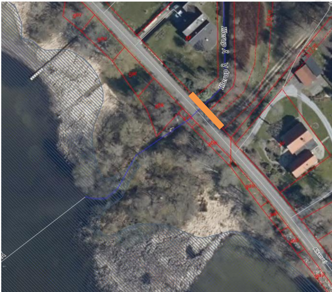
Figur 1: Krydsningspunkt (orange bjælke) under Illerup Å (ca. st. 7340) i vejmatrikel 7000d Alken By, Dover. Krydsningen sker via styret underboring.
